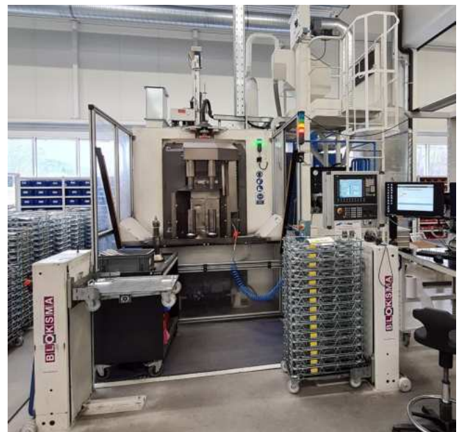
Eine „Shot Peening“ Anlage, konzipiert und betreut von der Schmölzer Industrietechnik GmbH
